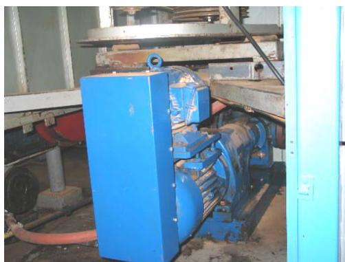
**FIGURA 4.10. BOMBA DE CARGA DE PRENSA**
