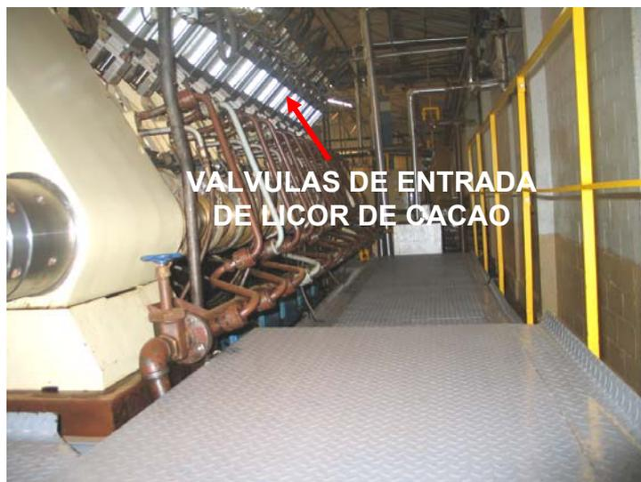
**FIGURA 4.9. VISTA DE PRENSA Y SUS VALVULAS**
