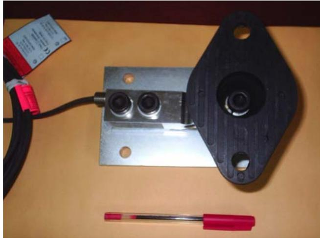
**FIGURA 3.26. CELDA DE CARGA**
