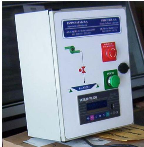
**FIGURA 3.27. PANEL DE CONTROL PESAJE DE TANQUE
