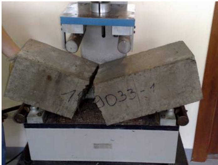
*Figura # 4.5 Viga ensayada a flexión*
