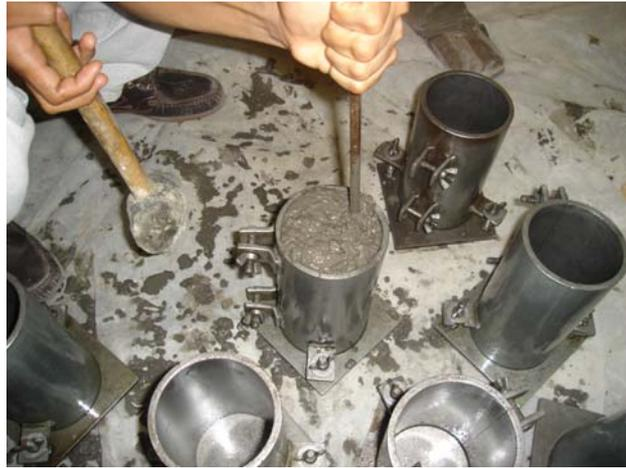
*Figura # 6. 13 Elaboración de cilindros*
