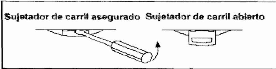
FIGURA 2.51. SUJETADOR DE CARRIL DIN.
