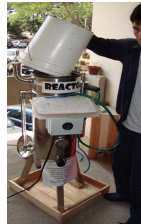
FIGURA 4.19 APERTURA DE TAPA Y LLENADO DE ACEITE
