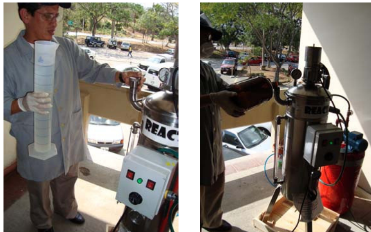
Figura 4.24 ADICIÓN DEL METÓXIDO AL ACEITE PRECALENTADO
