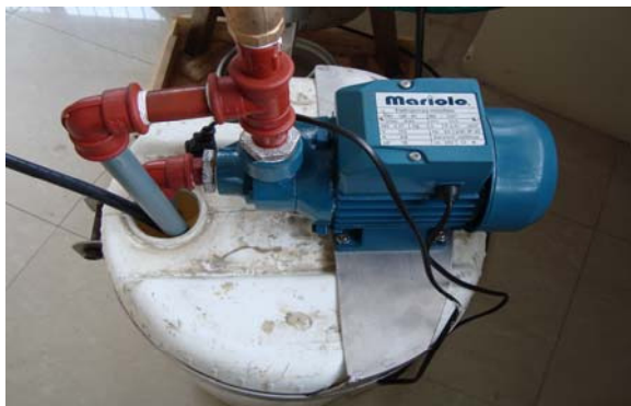
FIGURA 4.12 BOMBA MONOFÁSICA PARA CIRCULACIÓN DEL AGUA DE ENFRIAMIENTO
