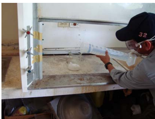
FIGURA 4.23 MEZCLA DE REACTIVOS, OBTENCIÓN DE METÓXIDO
