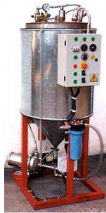
FIGURA 3.2 FOTO FRONTAL DE REACTOR DE TRANSESTERIFICACIÓN
