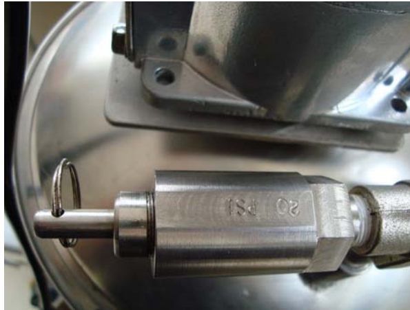
FIGURA 4.10 VÁLVULA DE SEGURIDAD
