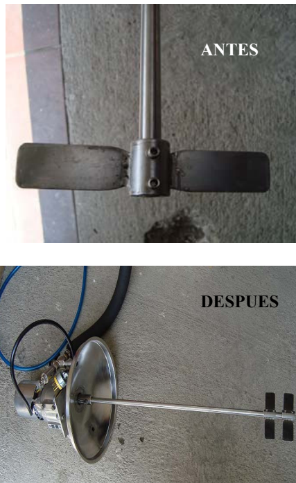
FIGURA 5.2 ANTES Y DESPUÉS DE LA ADICIÓN DE 1 PALETA AL IMPULSOR DEL REACTOR
