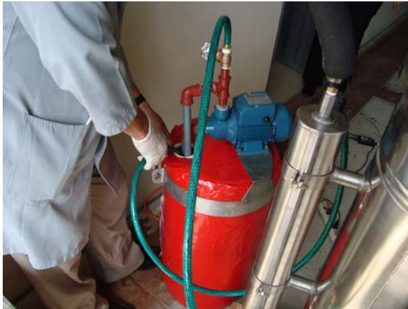
FIGURA 4.11 SISTEMA DE RECUPERACIÓN DE METANOL CONDENSADO
