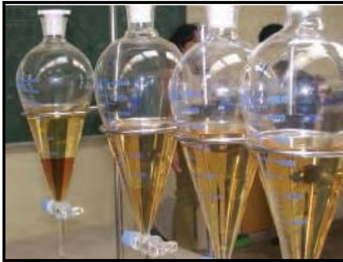
FIGURA 3.3 FOTOGRAFÍA ILUSTRATIVA DEL PROCESO DE DECANTACIÓN DE GLICERINA LUEGO DE LA TRANSESTERIFICACIÓN
