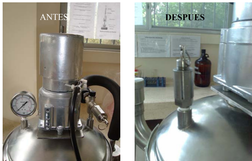
FIGURA 5.3 ANTES Y DESPUÉS DEL CAMBIO DE POSICIÓN E INCLINACIÓN DE LA VÁLVULA DE SEGURIDAD
