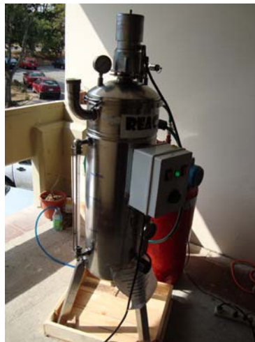
FIGURA 4.27 REACTOR DE TRANSESTERIFICACIÓN EN OPERACIÓN
