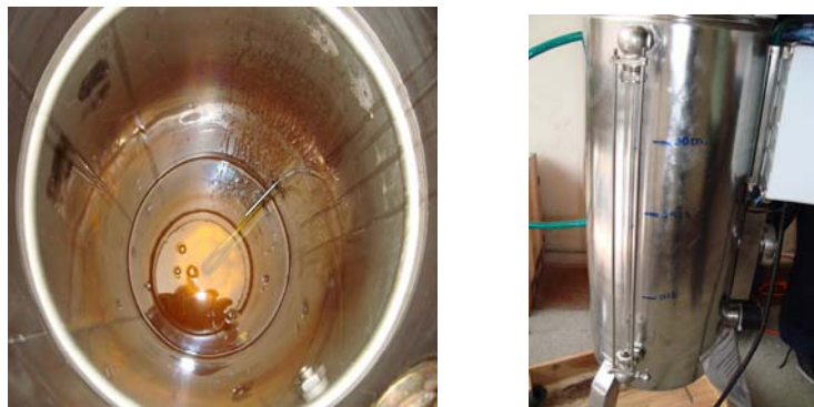
FIGURA 4.20 OBSERVACIÓN DE NIVEL DE ACEITE
