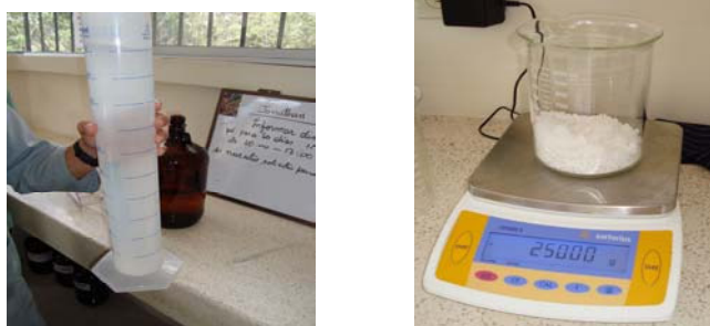
FIGURA 4.22 MEDICIÓN DE REACTIVOS
