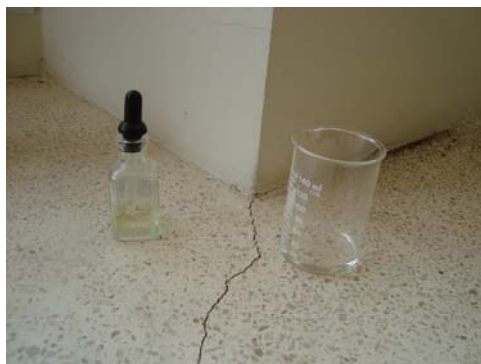
FIGURA 4.16 SOLUCIÓN DE FENOLFTALEINA Y VASO PARA MEDICIÓN DE PH
