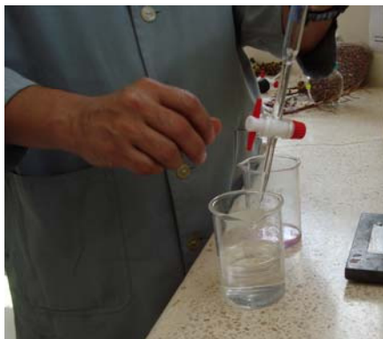
FIGURA 4.17 REACCIÓN DE TITULACIÓN
