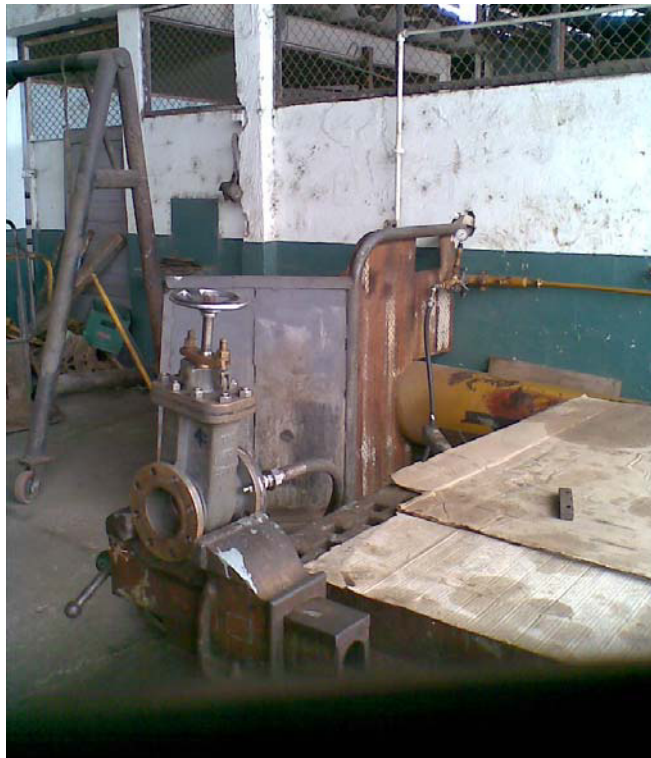
Figura 14.- Prueba de estanqueidad de una válvula de fondo
