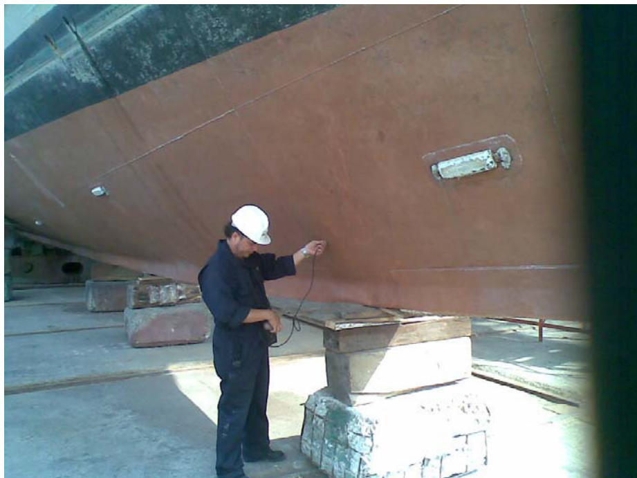
Figura 8.- Medición de Espesores
