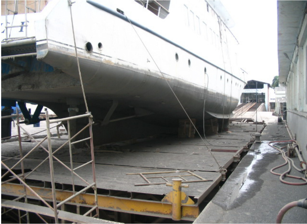
Figura 3.- Limpieza de casco
