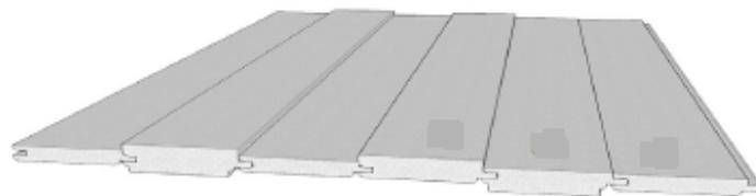
**Figura 1.2 Madera machihembrada**
