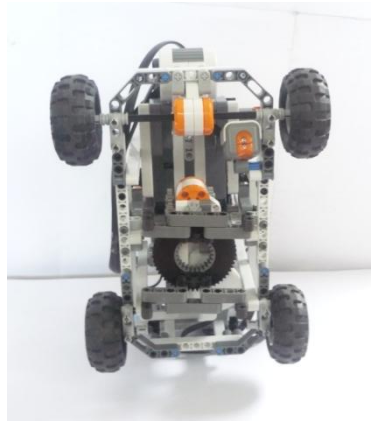
Fig. 3.1.2.1: Ubicación del Sensor de Luz en el Robot
