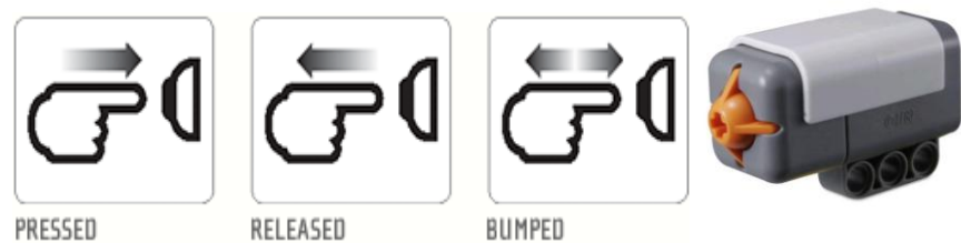
Fig. 2.3.2.1: Sensor de Contacto y sus posibles movimientos
