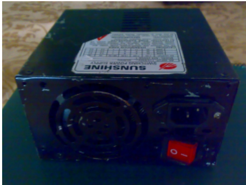
Figura 3.8. Módulo: Fuente de Poder.
