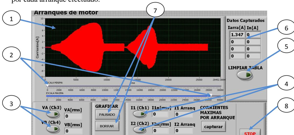
1 Pantalla gráfica de corriente 2 Slide de posición 3 Botonera de canales de voltaje 4 Botoneras de canales de corriente 5 Botón limpiar tabla de datos 6 Tabla de datos 7 Botonera del gráfico 8 Parada
