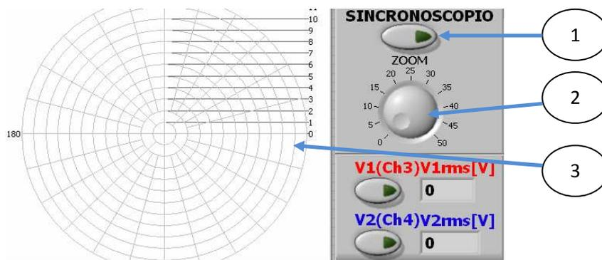
1 Botonera para activar el sincronoscopio 2 Perilla para ajuste de fasores 3 Diagrama fasorial del los generadores.
