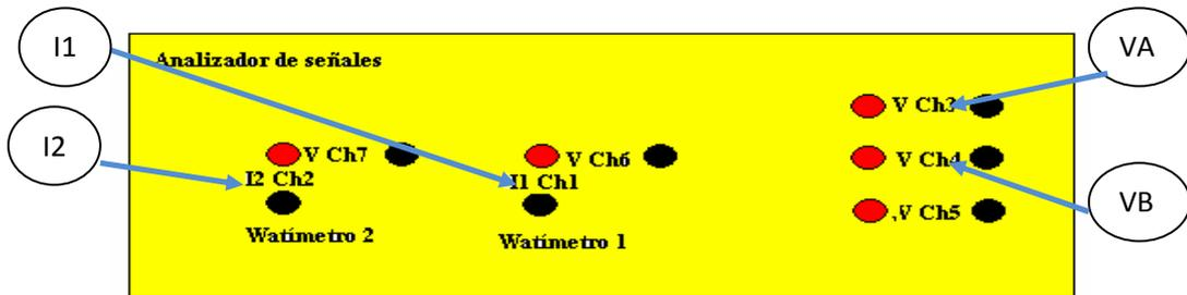
Figura 109. Conexión física del tablero
