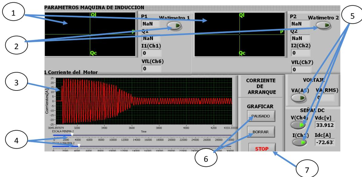
1 Pantalla gráfica del triángulo de potencias 2 Botoneras para habilitar los watímetros 3 Pantalla gráfica de corriente 4 Control para ampliar o disminuir el tiempo 5 Botoneras para habilitar los canales 6 Controles de la gráfica 7 Botonera de paro
