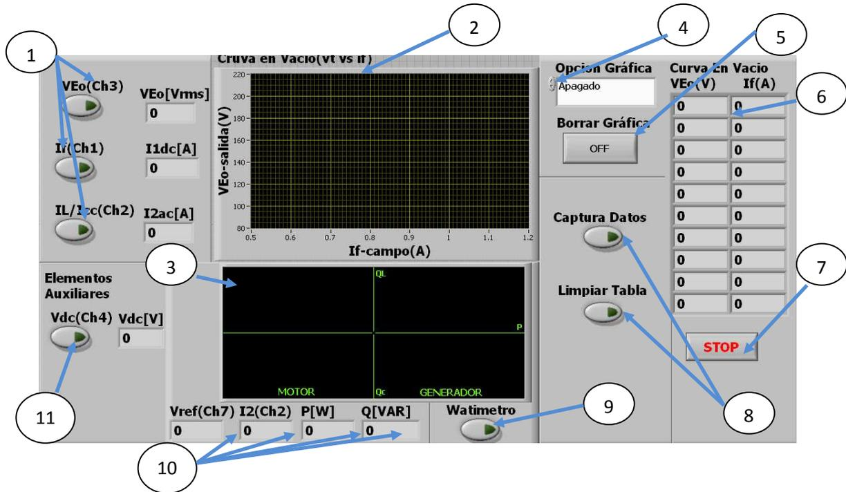
1 Botoneras de canales de voltaje y corriente 2 Pantalla gráfica de datos adquiridos 3 Pantalla grafica del triangulo de potencia 4 Elección de prácticas 5 Botón para borrar la grafica de datos adquiridos 6 Tabla de datos 7 Botón parada 8 Botoneras de control de datos adquiridos 9 Botón de watímetro 10 Celdas indicadora de voltaje, corriente, potencia activa y reactiva 11 Botonera de voltaje auxiliar
