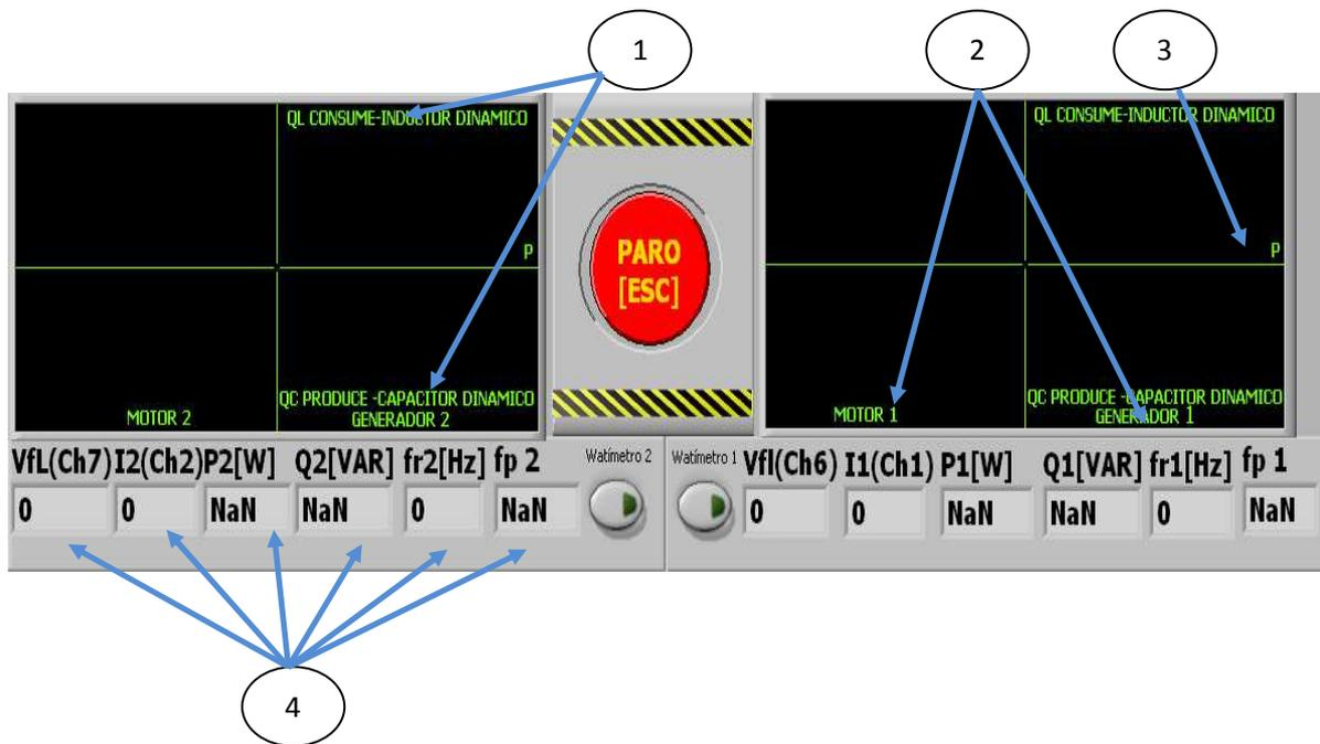
1 Indicador de consumo de reactivos QL o Qc 2 Información si está motorizado o generando el generador 3 Indicador de potencia activa 4 Campos indicadores de voltaje, corriente de línea, potencia activa, potencia reactiva, frecuencia y factor de potencia
