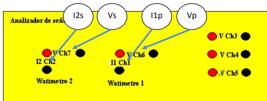
Figura 17. Conexión física del tablero
