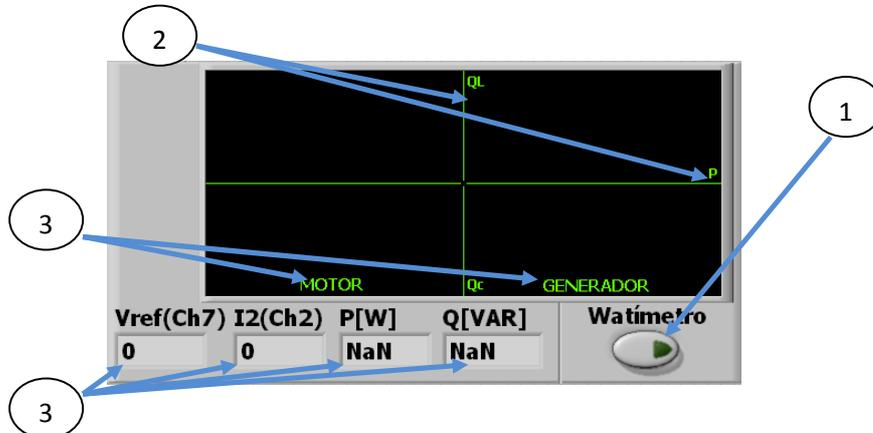
1 Botón de activación del watímetro 2 Y representa los reactivos y X la potencia activa 3 Indica si esta motorizado o generando 4 Campos indicadores de Vref, I2, P y Q
