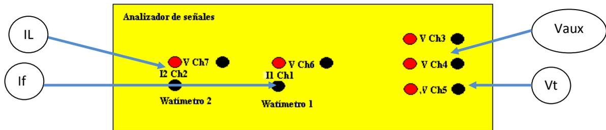
Figura 53. Conexión física del tablero
