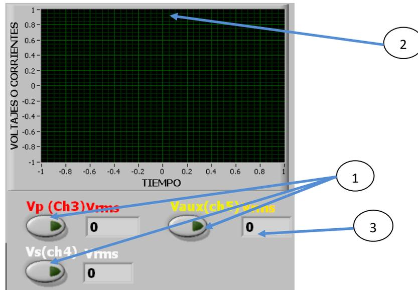
1 Botoneras de activación de canales 2 Pantalla gráfica 3 Celda indicadora de valores rms
