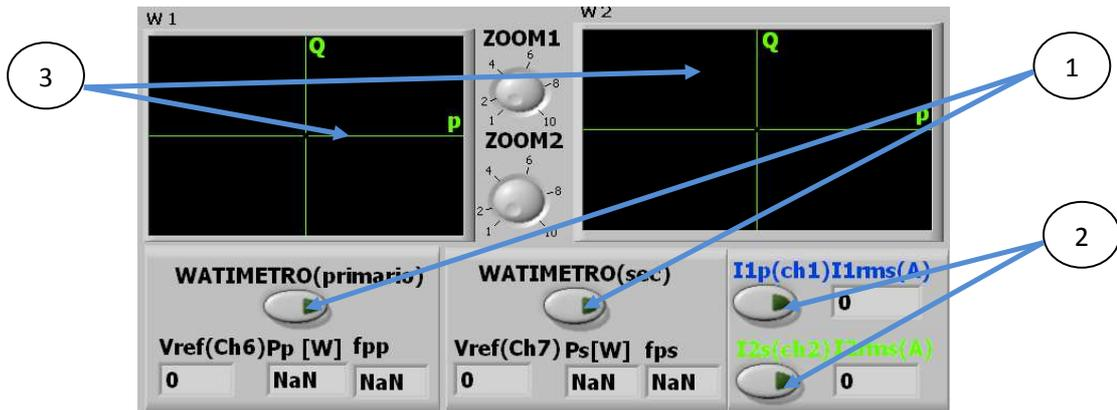
1 Botones para activar los watímetros 2 Botones para activar las corrientes 3 Pantalla gráfica del triángulo de potencia
