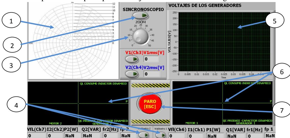
1 Pantalla de fasores o sincronoscopio 2 Botón para activar el sincronoscopio 3 Zoom de los fasores del sincronoscopio 4 Botoneras que activan los watímetros y voltajes 5 Pantalla gráfica de voltajes 6 Pantalla gráfica del triangulo de potencia 7 Botonera paro
