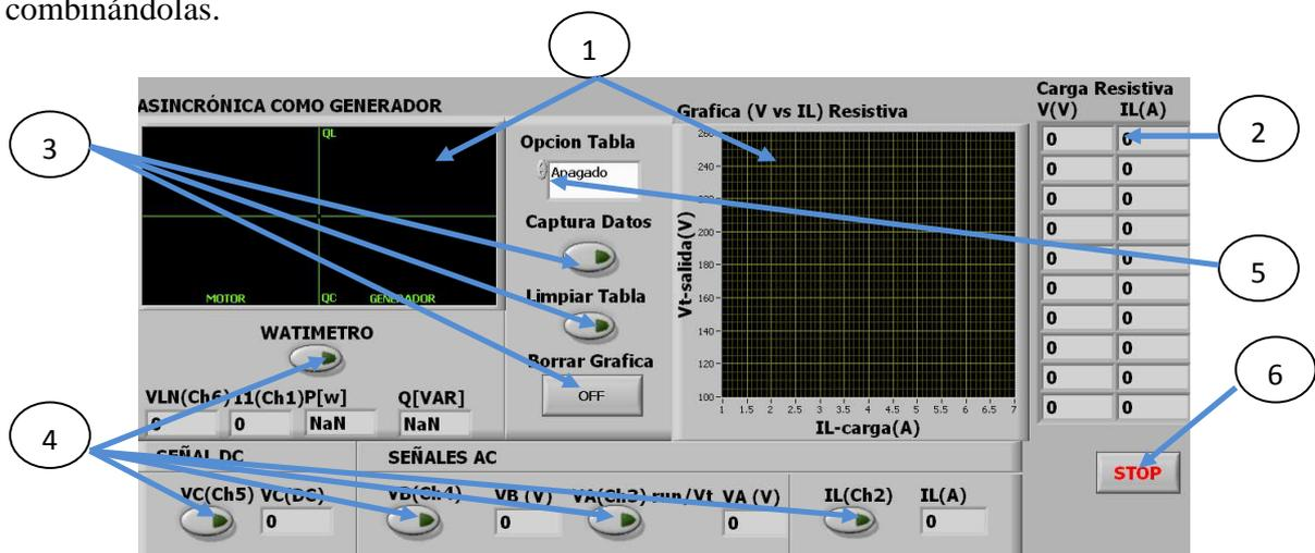
1 Pantallas gráficas de watímetro y datos 2 Tabla de datos 3 Controles de la gráfica de datos 4 Controles de los canales de voltaje y corriente 5 Control de las prácticas 6 Botonera paro.
