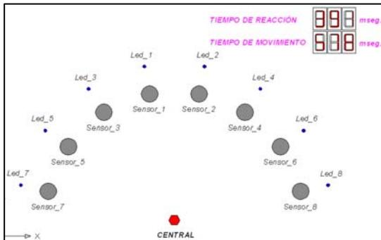
**Figura 9.** Distribución de la botonera central, indicadores luminosos, sensores táctiles y despliegues visuales en el equipo.
