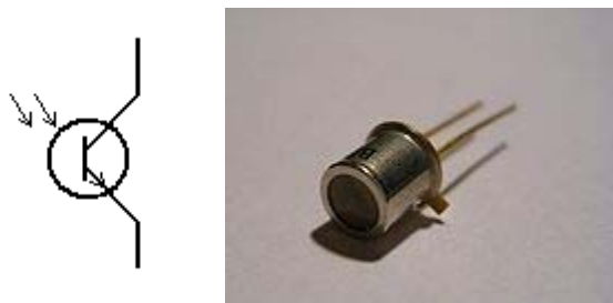
Fig. 2.1.13 El Fototransistor, simbología y encapsulado
