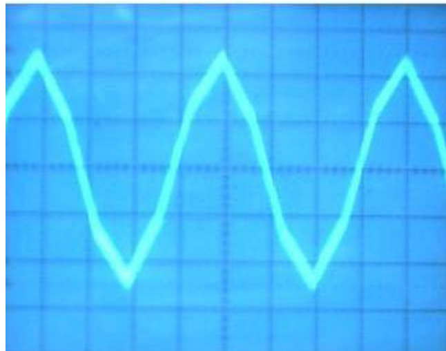
Foto 7: Corriente de L-N para carga R-L conectada en estrella (experimental)
