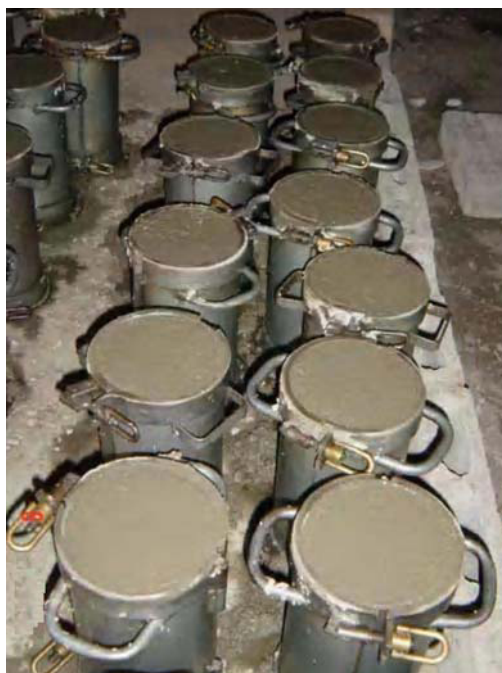
Fotografía 4.2.- Cilindros de hormigón para ensayo de compresión.
