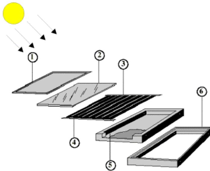
En el esquema vemos cómo está constituido el componente colector de energía solar:
