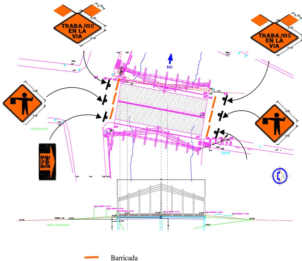
**FIGURA 50. DISPOSICIÓN DE SEÑALES DURANTE LA CONSTRUCCIÓN.**
