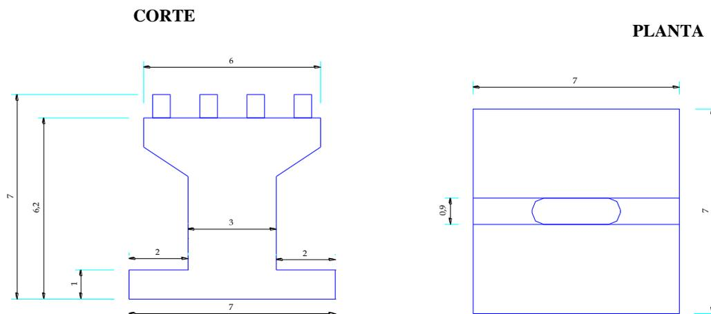
**FIGURA 39. DETALLE DE LAS PILAS A UTILIZARSE EN LA AMPLIACIÓN.**
