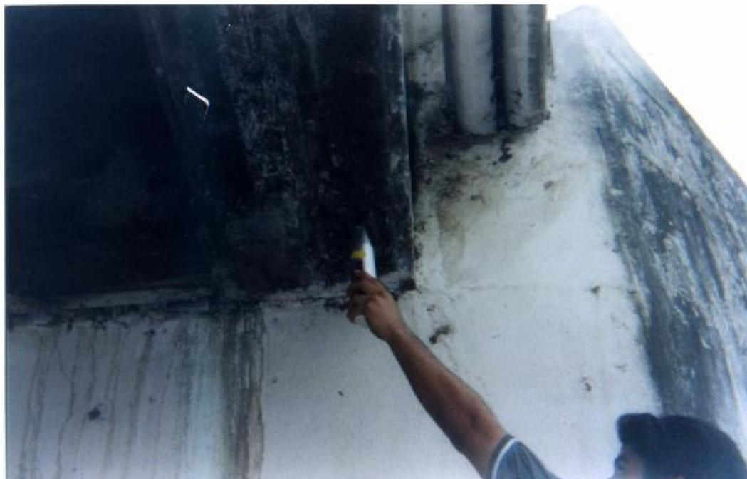
**FIGURA 15. ENSAYO ESCLEROMÉTRICO EN VIGAS**
