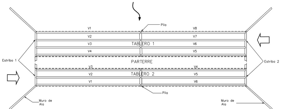
**FIGURA 1. ESQUEMA DEL PUENTE 17 DE SEPTIEMBRE.**
