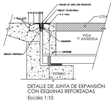
DETALLE DE JUNTA DE EXPANSIÓN
