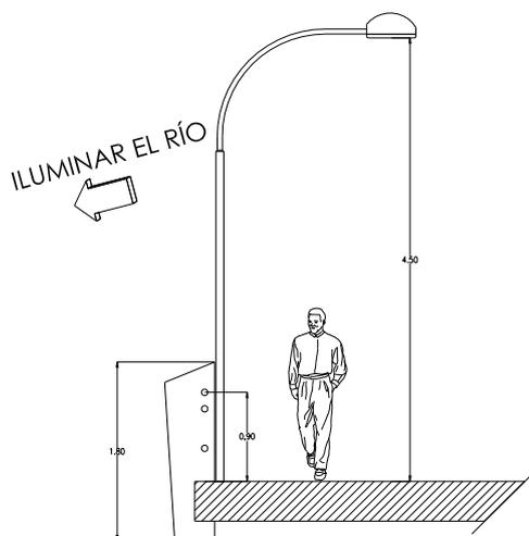
**FIGURA 26. ESQUEMA BÁSICO DE LUMINARIA DEL PUENTE.**
