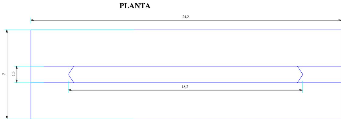
**FIGURA 42. DETALLES DE PILA CENTRAL PROPUESTA EN LA RECONSTRUCCIÓN DEL PUENTE 17 DE SEPTIEMBRE.**
