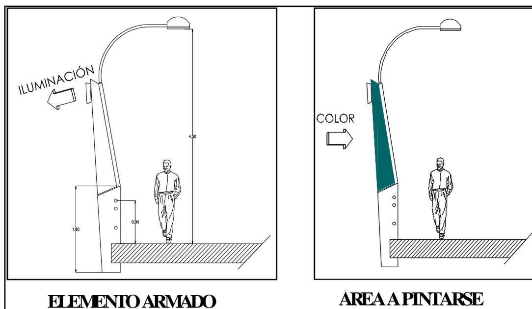
**FIGURA 28. DISEÑO FINAL DE LUMINARIA PROPUESTA.**
