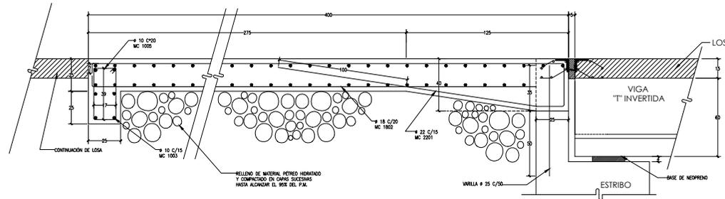
DETALLE DE LOSA DE TRANSICIÓN
