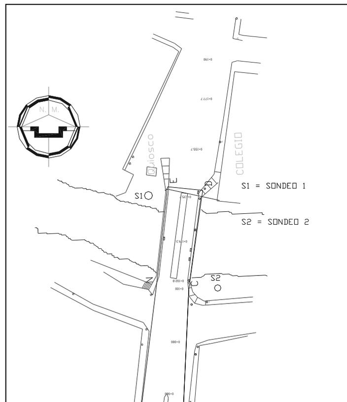
**FIGURA 36. UBICACIÓN DE SONDAJES EN EL PUENTE 17 DE SEPTIEMBRE**
