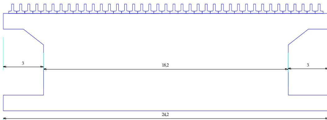
**FIGURA 43. DETALLES DE PILA CENTRAL PROPUESTA EN LA RECONSTRUCCIÓN DEL PUENTE 17 DE SEPTIEMBRE.**
