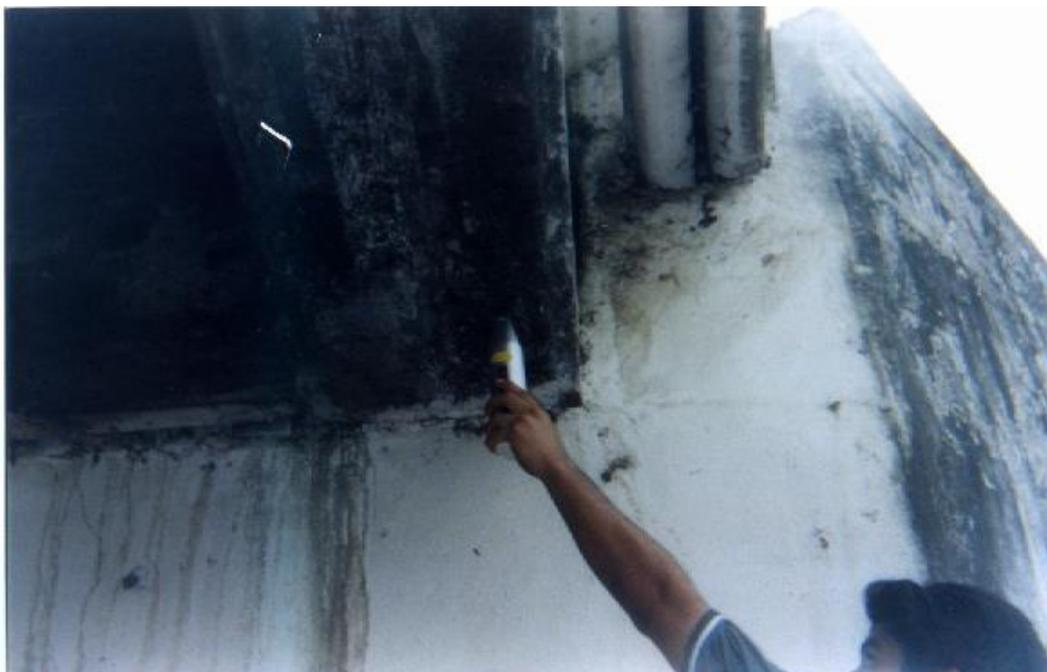
**FIGURA 15. ENSAYO ESCLEROMÉTRICO EN VIGAS**
