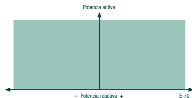
Diagrama de la potencia límite de un ENERCON E-70 con características STATCOM
