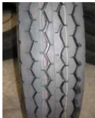
FIGURA 1.5 BANDA CON ACANALADURAS Y NERVIOS
