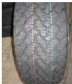
FIGURA 1.5.A BANDA CON ACANALADURA EN SENTIDO TRANSVERSAL
