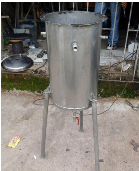
Tanque luego del proceso de Soldadura TIG
