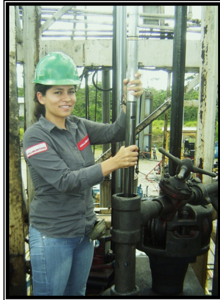
FIGURA 2.22. LANZAMIENTO DEL FAST GAUGE DESDE SUPERFICIE
