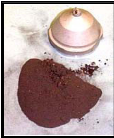
FIGURA 2.7 CARGAS CON LINER DE ACERO (FUENTE: HALLIBURTON)
