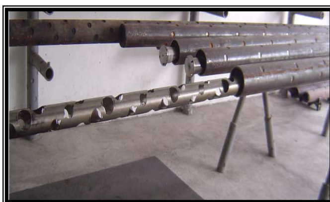
FIGURA 2.11. CAÑONES Y REGLETAS PORTA CARGAS (FUENTE: HALLIBURTON)
