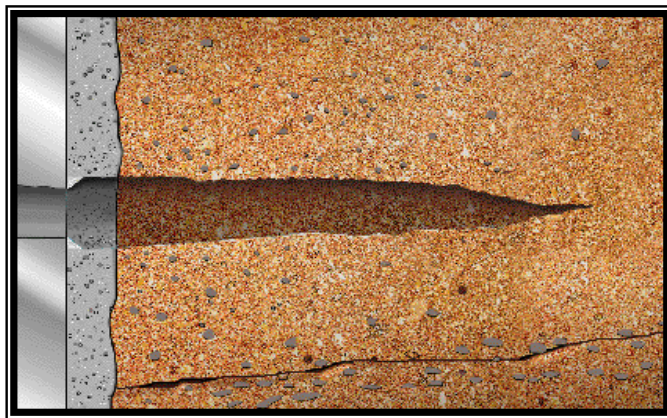
FIGURA 2.14. B) FUENTE: HALLIBURTON; SITUACIÓN IDEAL EN UN PUNZADO (TÚNEL LIMPIO) (FUENTE: HALLIBURTON)
