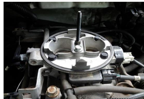
Figura 10. Cuerpo de aceleración instalado en el múltiple de admisión.
