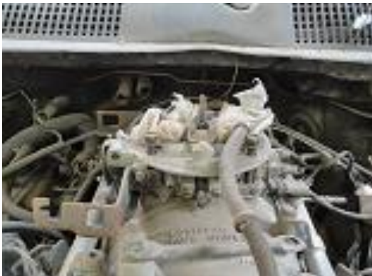
Figura 1. Cuerpo de aceleración en mal estado
