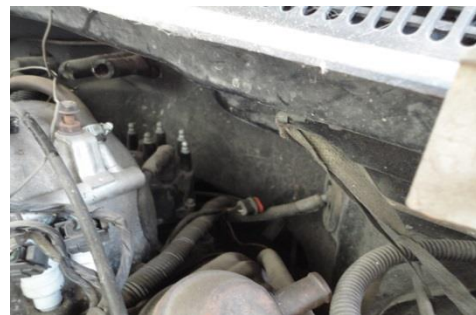
Figura 2. Distribuidor sin cables de bujías
