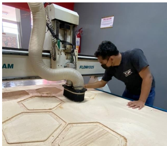
Figura 33: Corte de piezas en máquina CNC Router
