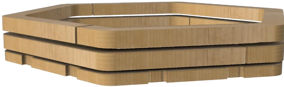
Figura 35: Colocación de segunda fila de piezas en forma de L
