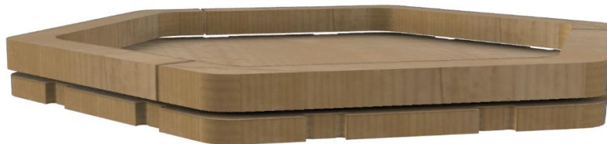
Figura 34: Colocación de primera fila de piezas en forma de L
