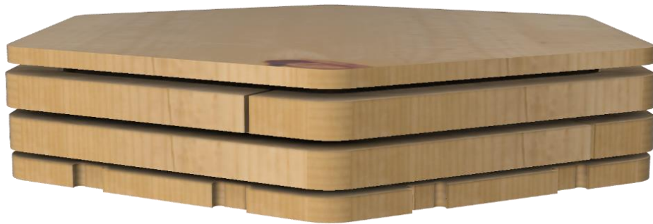
Figura 36: Tapa embonando en la caja
