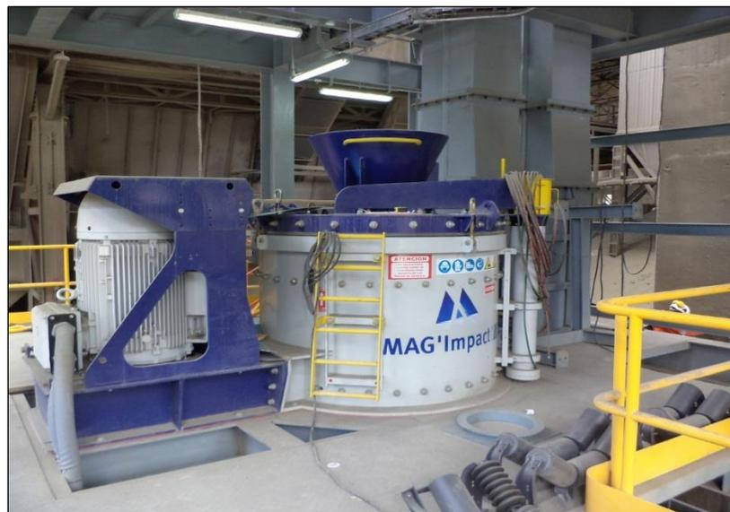
**FIGURA. 3.19 MONTAJE DE TRITURADORA EN EDIFICIO, CON SISTEMA MOTRIZ LATERAL.**
