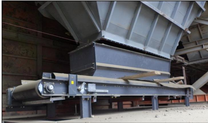
**FIGURA 2.19 BANDA DOSIFICADORA SECADO DE PUZOLANA.<sup>11</sup>**
