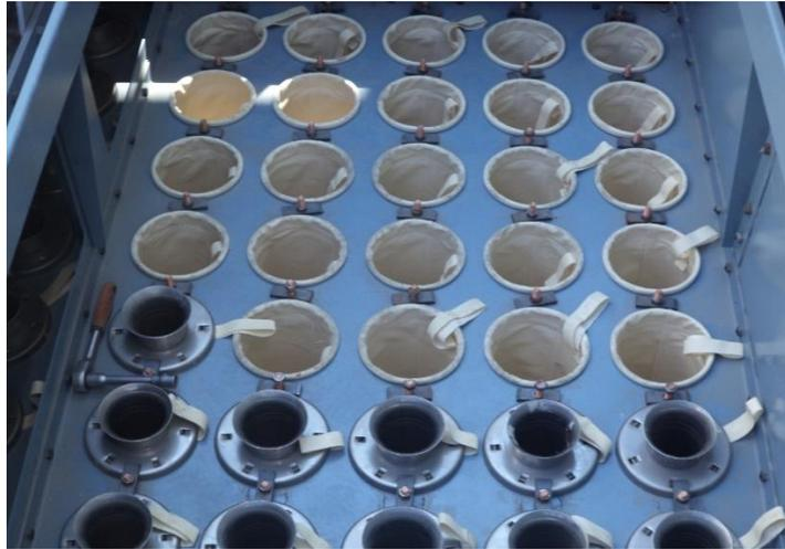
**FIGURA 3.10. MONTAJE DE MANGAS Y CANASTILLAS DE FILTRO DEL SECADOR.**
