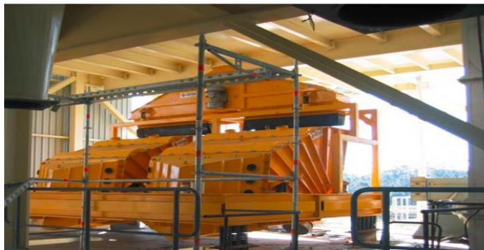
**FIGURA 2.65 Criba vibratorio con repartidor vibrante**
