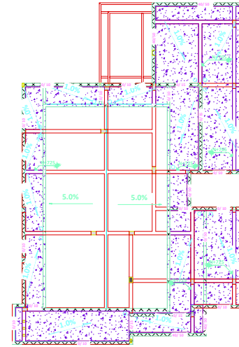
1 : 100 Muros y pendientes de cubierta
