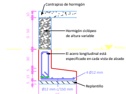
1:20 Sección de zapata excéntrica
