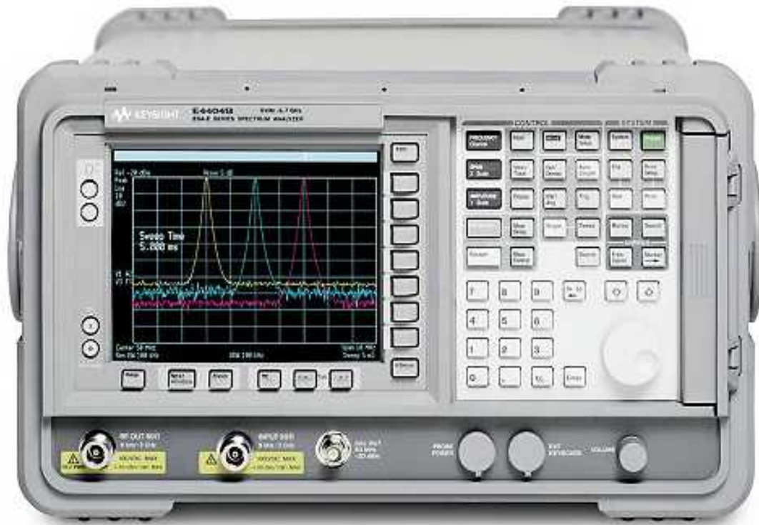
Figura3.8: Analizador de Espectro E4404B[38]
