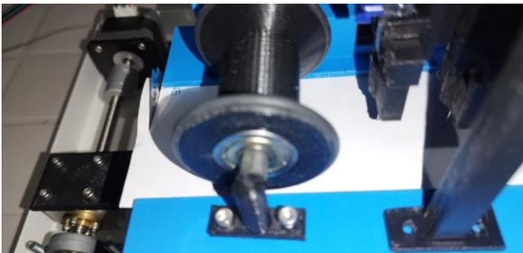
En la Figura 3.16 se puede observar el sistema de corte que está diseñado para dividir la membrana de 30 cm en segmentos de 0.4 cm, el mecanismo realiza el corte desplazándose de derecha a izquierda, regresando luego a su posición inicial, mientras que el avance de la lámina es controlado por sensores ópticos que detectan cada 0.4 cm. Cada ciclo (avance, corte y retorno)
