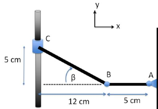
7. En la figura que se muestra, el eslabón AB tiene velocidad angular en el sentido de las manecillas del reloj de  $7 \text{ rad/s}$  y una aceleración angular de  $5 \text{ rad/s}^2$ . El collarín en C se desliza verticalmente hacia arriba por una varilla fija. La aceleración del punto B es:
