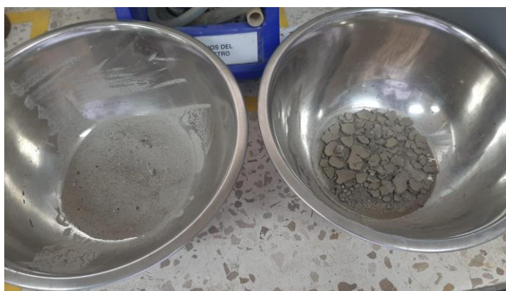
Figura 2.6 Muestras secas retenidas en tamiz No. 200 tras lavado. Fuente: [Propia]
