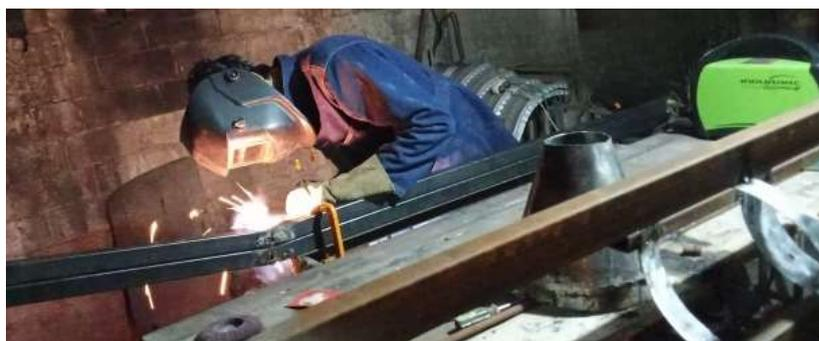
Después de realizar los cortes correspondientes, se soldaron los aros de fijación a los tubos cuadrados para conformar la estructura del secador. En la figura 33 se observa la estructura del secador vertical de biomasa, la cámara de secado y el cuerpo del sistema de generación de calor. Una vez finalizado el armado y la soldadura de las piezas, se procedió con el ensamblaje de la estructura, completando los ajustes y retoques finales necesarios.
