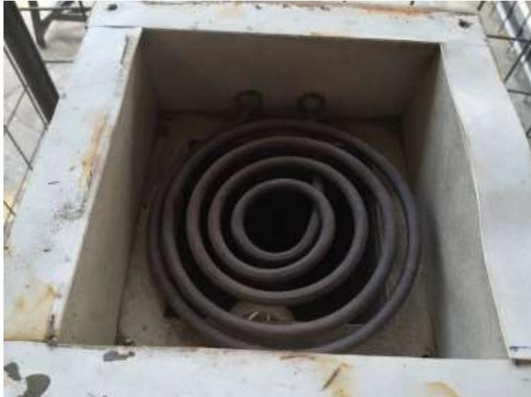
*Nota:* Resistencia eléctrica tipo espiral de 220VAC.
