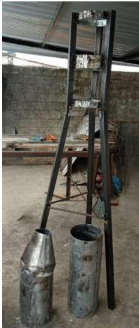
*Nota:* Estructura, cámara de secado y cuerpo del sistema de generación de calor.
