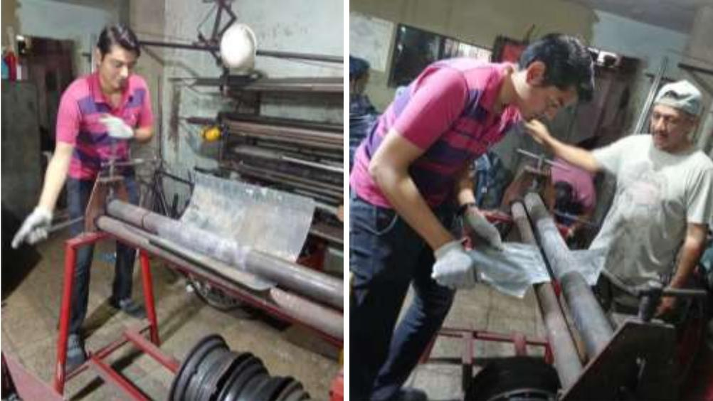
*Nota:* la izquierda el rolado del cuerpo de la cámara de secado, a la derecha el rolado del cuerpo del sistema de generación de calor.
