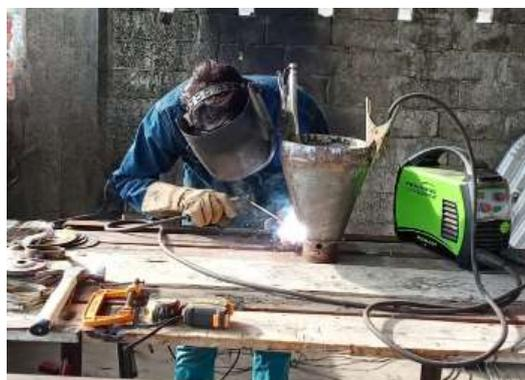
Después del armado de las piezas, se procedió a construir la estructura del secador vertical. Como primer paso, se ensamblaron los aros que asegurarán la fijación de la cámara de secado a la estructura. En la figura 31 se muestran los tres aros necesarios para sujetar la cámara de secado, garantizando un ensamblaje y fijación adecuados.
