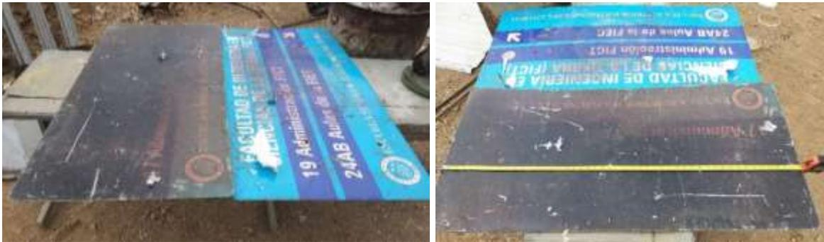
*Nota:* Planchas de acero estructural utilizadas (1220 x 610 x 1 mm cada una) entregados por el laboratorio del CDTs para la fabricación de los componentes del rediseño del secador vertical de biomasa.
