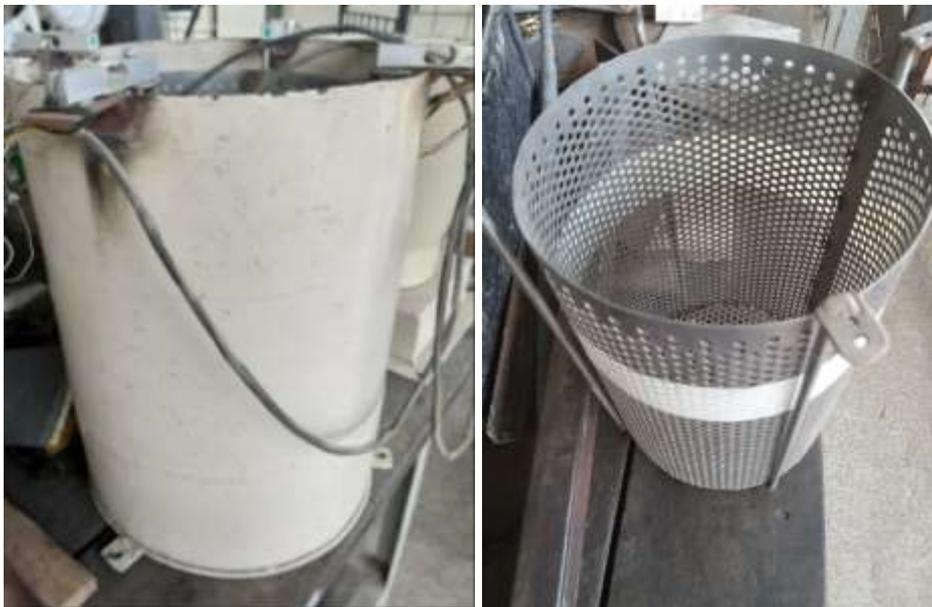
*Nota:* A la izquierda estructura de la cámara de secado, a la derecha, canasta de colocación de la biomasa
