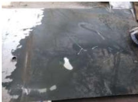
Posterior a la limpieza de las planchas de acero estructural, se procedió al corte de estas para realizar el rolado con las dimensiones según indica el Plano #3 ubicado en el *Apéndice A*. La figura 25 indica una dimensión de 220 mm de diámetro por 1000 mm de alto, no obstante, para facilidad de ensamblaje, se decidió dividir la cámara de secado en dos partes. Las dimensiones de la cámara de secado antes del rolado son de 600 x 71 mm y la otra parte de 400 x 71 mm.
