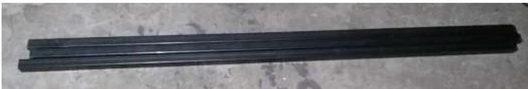
*Nota:* Tubo de acero estructural de 1 ½ pulg. x 6000 x 2mm.
