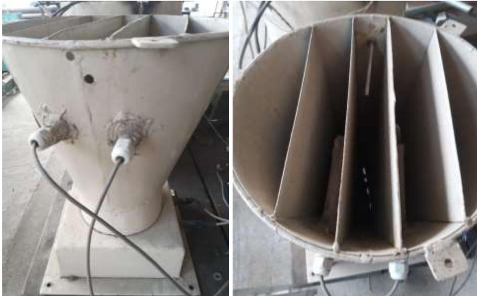
*Nota:* A la izquierda la base de la expansión y a la derecha una vista superior de los baffles de rectificación del flujo de aire.
