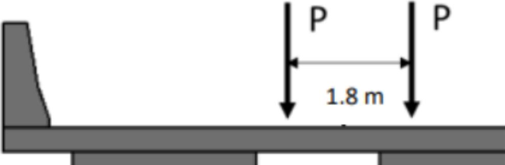
Imagen 59 Carga de camión de diseño en interacción con la losa del puente. [ Canales & Fienco, 2022]
