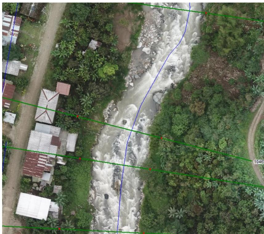
Imagen 33 Vista en planta abscisa 1+046Km; viviendas amenazadas por la socavación en la margen derecha. [Canales & Fienco, 2022]
