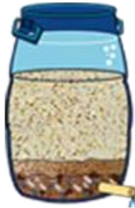
Figura 2.9: Etapa de Filtración de una planta potabilizadora
