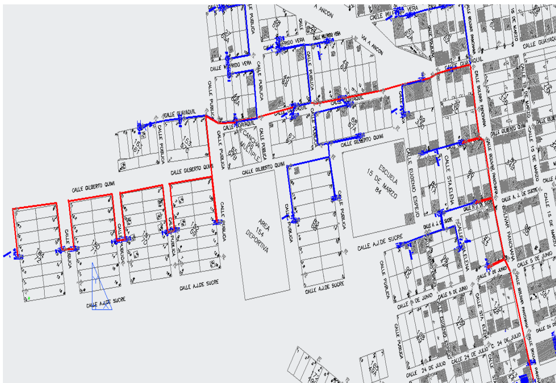
Figura 3.32 Primer cable de distribución del MT01
