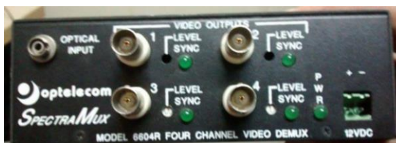
Figura 3.8 Conversor Óptico- Eléctrico usado por Canal Cable Deportes
