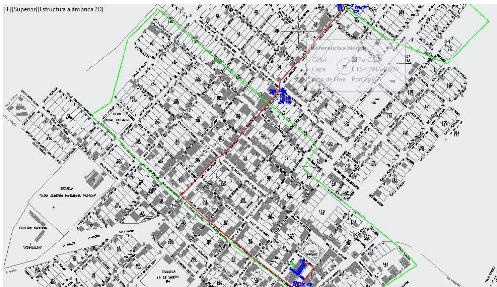
Figura 3.25 Diseño de la Red Feeder en AutoCAD
