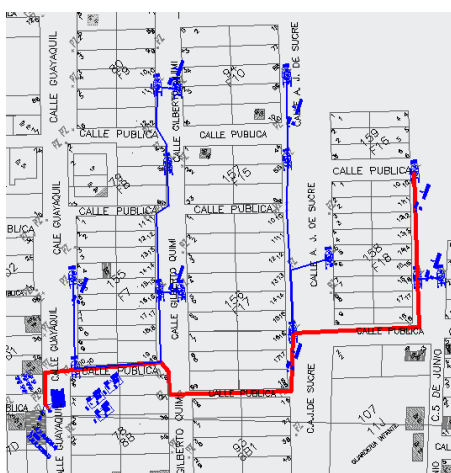
Figura 3.45 Tercer cable de distribución del MT04
