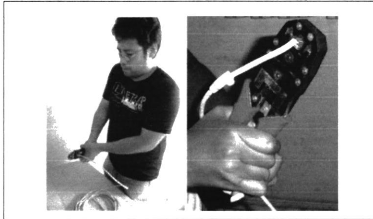
Figura 4-12: Haciendo presión sobre el conector RJ45 con la pinza ponchadora RJ45.
