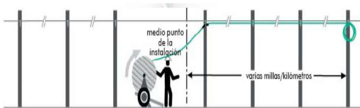
Figura 2.26. Extracción de cable al punto medio
