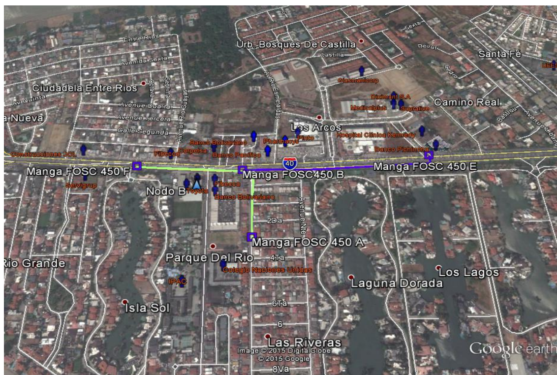
Figura 3.12 Tendido de la Fibra y ubicación de las Mangas de Empalme parte #3
