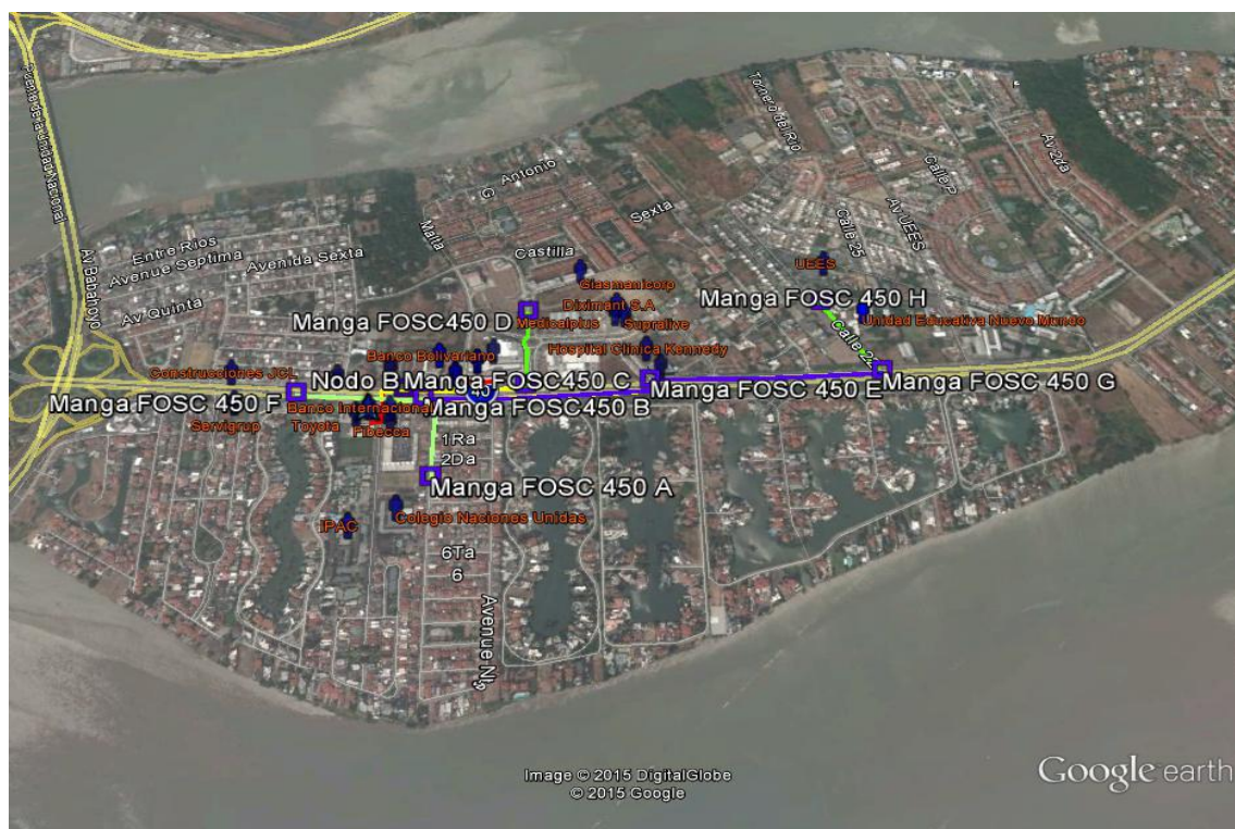
Figura 3.13 Tendido de la Fibra y ubicación de las Mangas de Empalme
