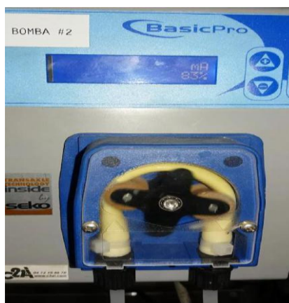
Figura 4.18: Bomba 2 trabajando al 83% mientras trabaja el compensador discreto
