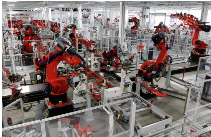
Figura 1.8 Ejemplo de automatización flexible en fábrica de “Tesla Motors”.
