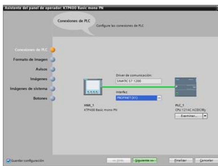
Figura 3.33 Confirmación de la conexión entre el PLC Y HMI.
