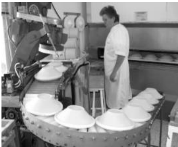
Figura 1.6 Ejemplo de automatización fija con máquina de fabricación de platos.
