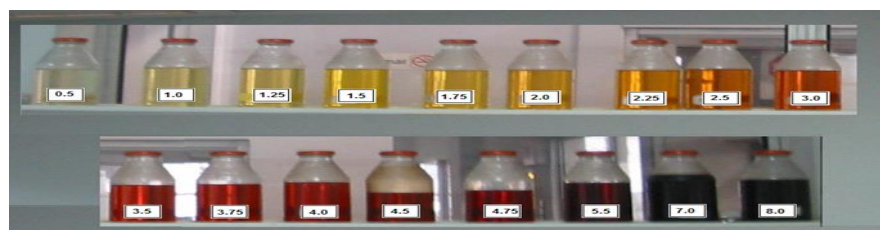
Figura 1.2: Degradación del aceite según norma ASTM D-1500
