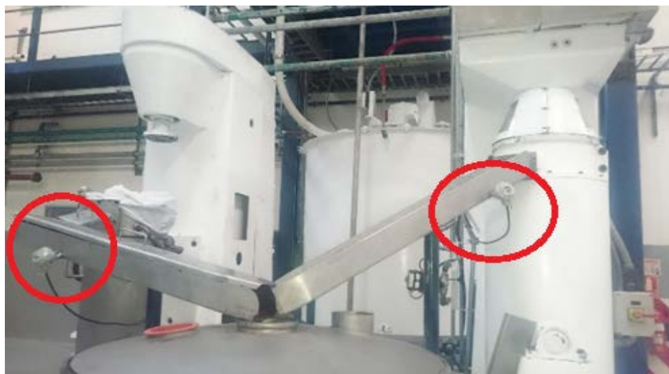
Figura 2.4: Pt100 en la salida de los molinos de bolas.
