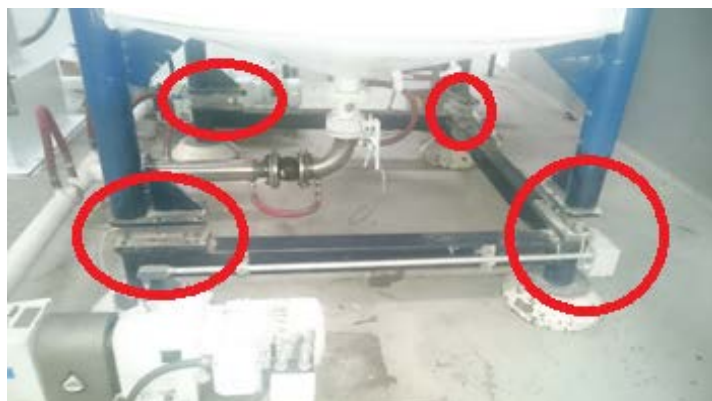
Figura 2.3: Celdas de carga en el tanque de homogenizado de licor de cacao
