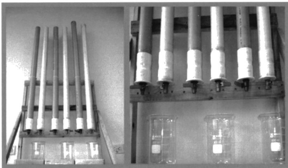
a) Columnas de filtración en PVC      b) Llaves de salida del agua filtrada
