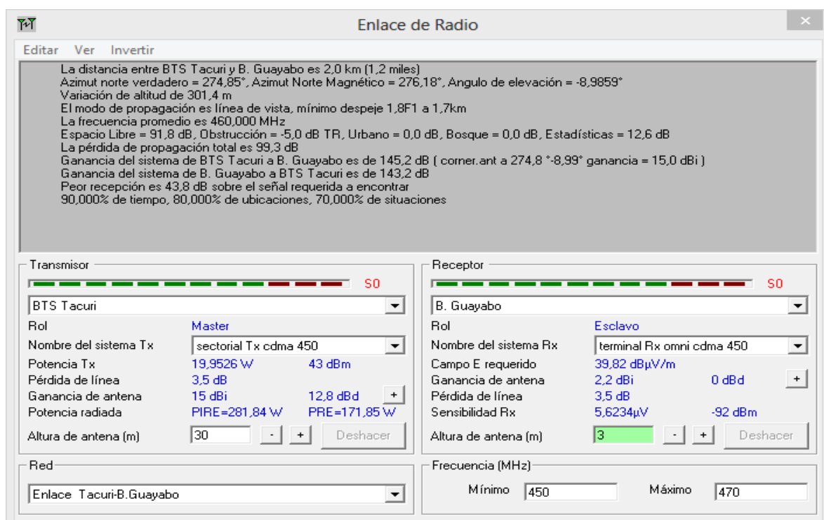
Figura 4.32 Radio enlace BTS Tacuri – B. Guayabo
