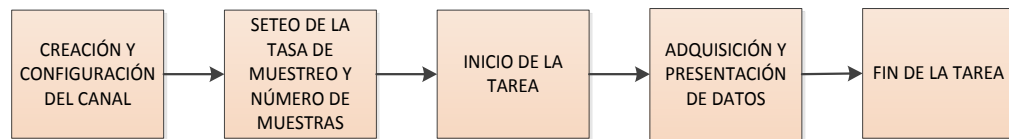
Figura 2.4 Diagrama de bloques de medidor de corriente y voltaje virtual.
