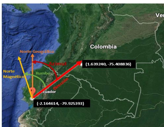
Figura 2.10 Ángulo de azimut entre 2 puntos geográficos.
