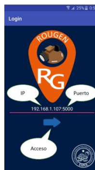
Fig 3.2. Comunicación aplicación android con raspberry.
