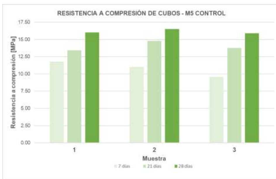
Figura 6.2 Diagrama de barras de resistencia a la compresión de M5 control
