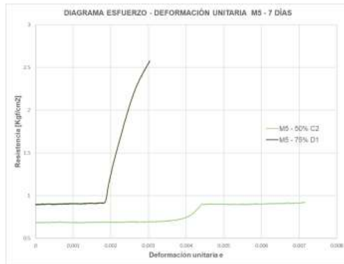
Figura 6.14 Diagrama esfuerzo - deformación M5 50% C y 75% C a los 7 días
