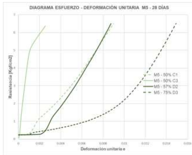
Figura 6.15 Diagrama esfuerzo - deformación M5 50% C y 75% C a los 28 días
