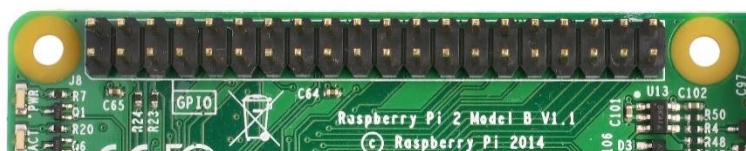
Figura 2.1: GPIO en Raspberry Pi, interfaz de conexión con otros dispositivos electrónicos [16]
