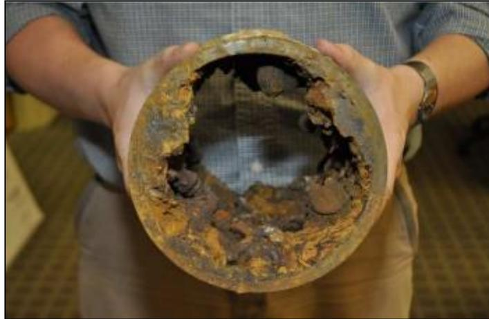
**Figura 1.3** Presencia incrustaciones en tubería de acero [12]
