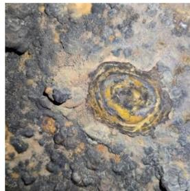
**Figura 3.11 Superficie donde se observa perforación de la incrustación**
