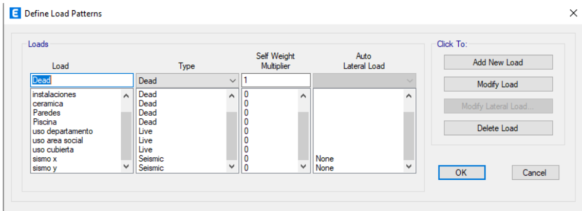
Ilustración 27.- Definición de cargas sísmicas. (Fuente: PAnE)
