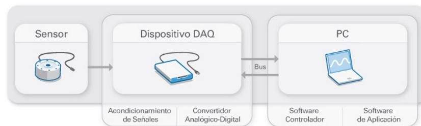
**Figura 3.7:** Partes de un sistema DAQ.
