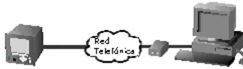
Figura 4.13.- Comunicación de un medidor vía Módem.
