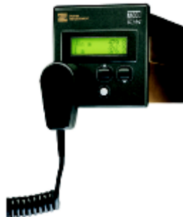
Figura 4.4.- Lector óptico acoplado al medidor.
