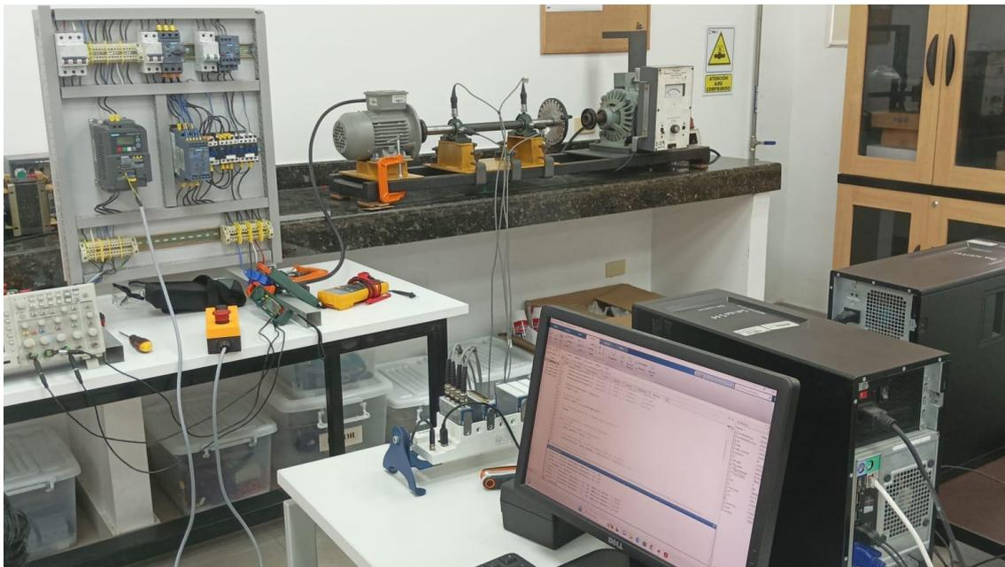
*Nota:* Ilustración del prototipo de validación para las pruebas de vibraciones y calculo de masa de balance.
