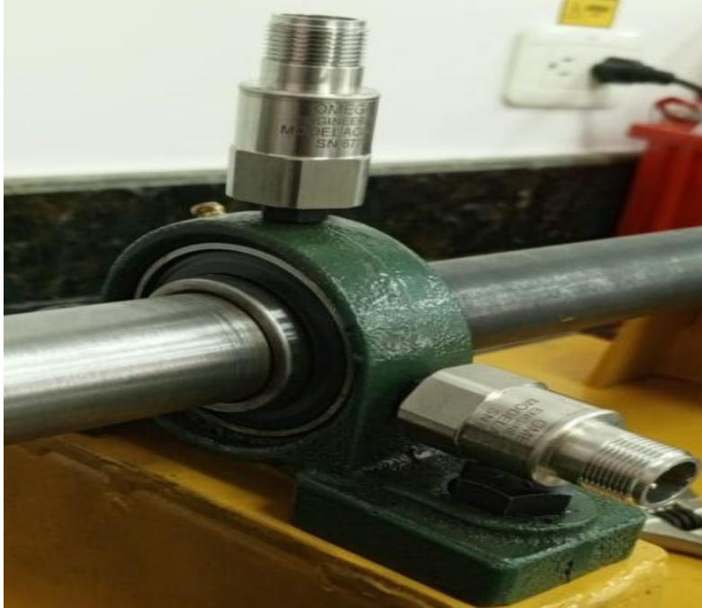
*Nota:* La figura muestra el montaje de los acelerómetros en las chumaceras de piso UCP206-20 para la toma de medición de vibraciones del sistema.
